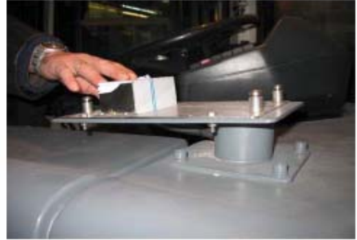
Detalles del soporte base de las expendedora de billetes, como se puede observar es fijo y no admite regulación alguna. Fotografías de vehículos que aún no han entrado en servicio.
