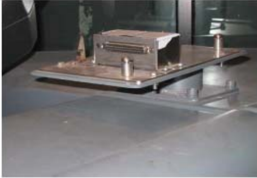
Detalles del soporte base de las expendedora de billetes, como se puede observar es fijo y no admite regulación alguna. Fotografías de vehículos que aún no han entrado en servicio.
