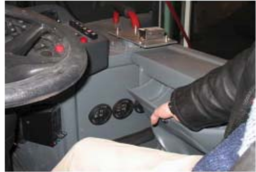
Disposición de los cajones para el cambio y soporte de máquina, obsérvese la postura de la mano en los cajones.
